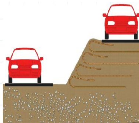
بکارگیری ژئوگریدها در تسلیح خاکریزها و شبروانیها
