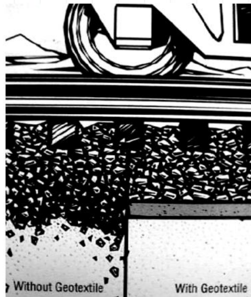
استفاده از ژئوگریدهایی با منافذ ریز و یا بکارگیری آنها به همراه یک لایه ژئوتکستایل دیگر، موجب جلوگیری از رانده شدن سنگ دانه ها به درون خاک نرم بستر، جداسازی میان لایه خاک بستر و سنگ دانه ها و نهایتاً افزایش طول عمر راه آهن میشود.
